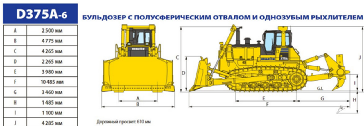
Рисунок 3.4 – Габаритные размеры бульдозера Komatsu D375A
