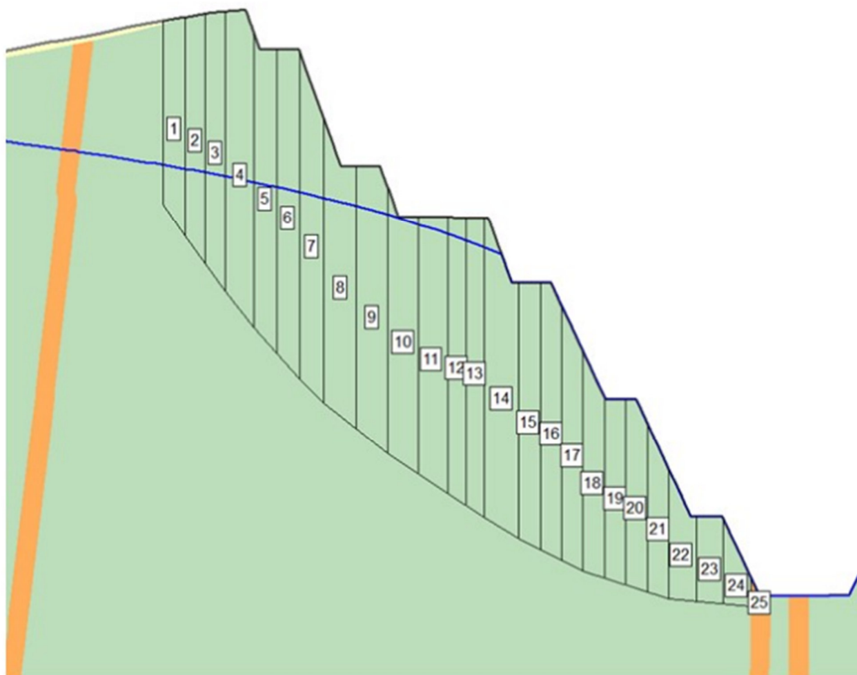
Рисунок Г.2 – Схема расчета борта карьера по профилю 2, ПС-1
